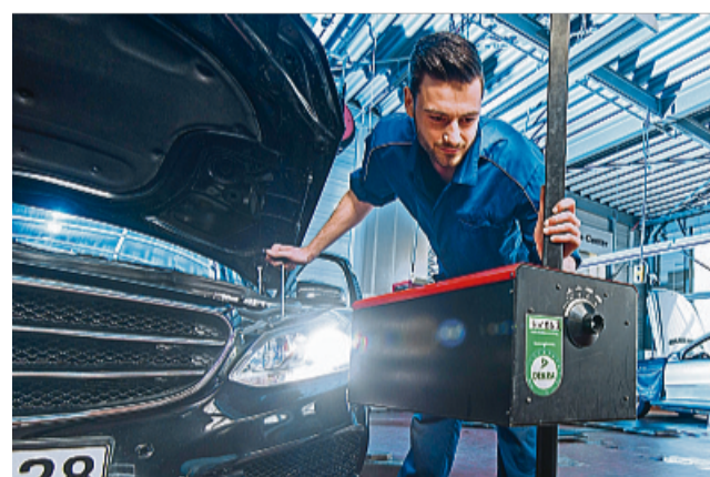
Die richtige Einstellung der Autoscheinwerfer ist ohne die entsprechende Ausrüstung nicht möglich.
